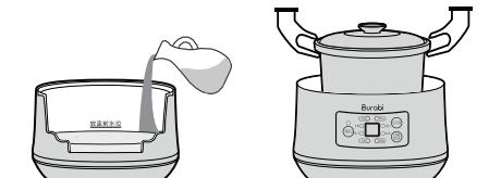
3.1.2 按机体内侧的水尺加入适量的水,再将装好食材的炖盅放入机体。
