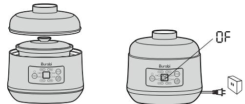
3.1.3 盖好上盖,接通电源,进入待机状态,面板显示“OF”。
